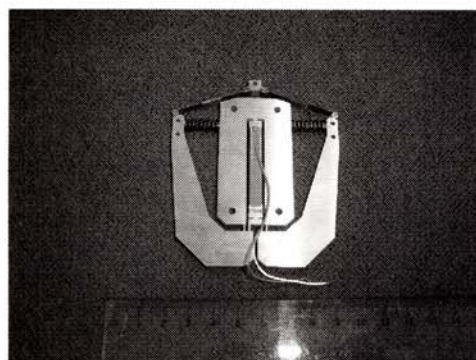
金属部板厚：4.8mm 発生変位： 1600\mu\text{m} 発生力：5N 外形寸法：91(H)×77(W)
