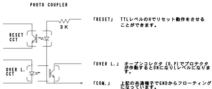
上記の回路をリモートコントロールすることにより、プロテクタの作動状態の認識と復帰操作を外部で制御が可能になります。なお、外部の「RESET」信号と正面パネルの
